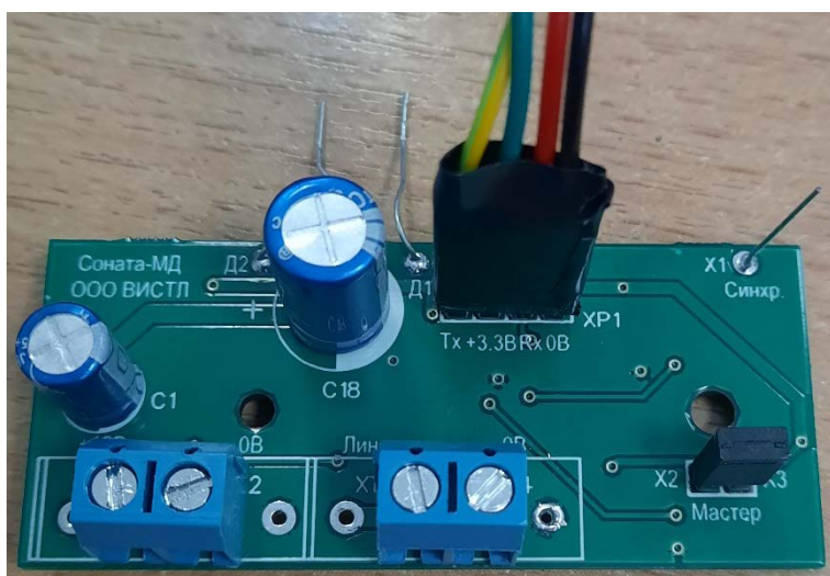
Рисунок 2. Соединение ответной части межплатного провода со штыревой вилкой XP1
